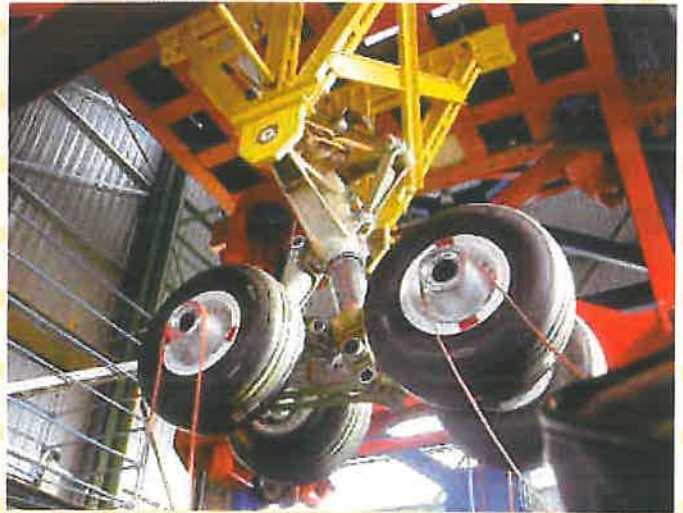
Landställsprov på Airbus A340 mittre huvudställ. Landstället belastas (upp till 200 ton för A380), hjulen spinns upp till sättningsfart och landstället släpps till marken.
