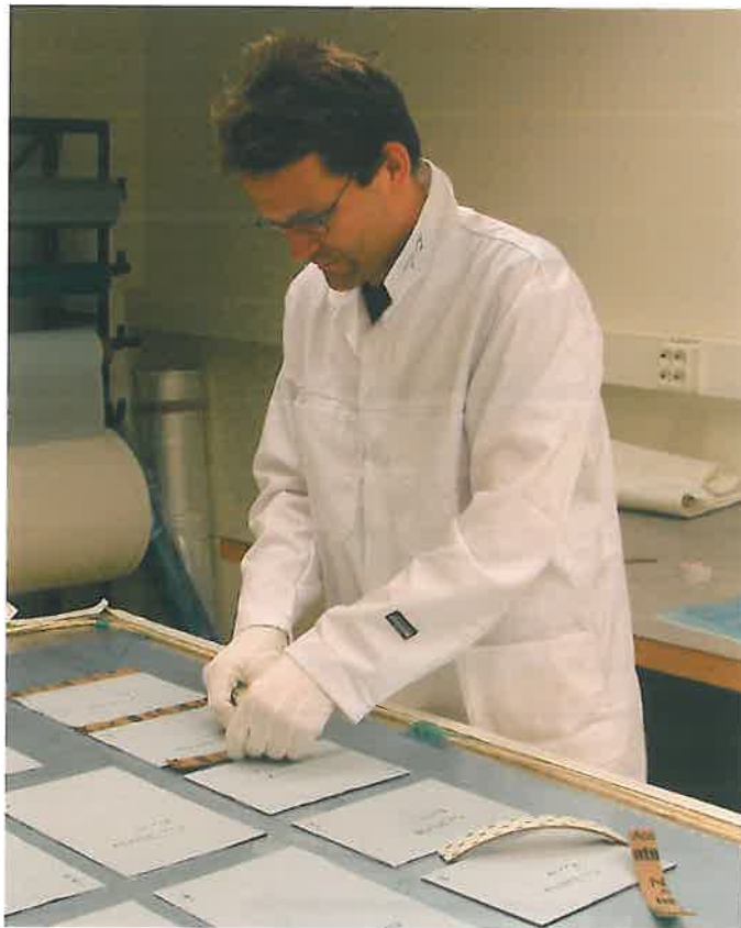
Tillverkning av kolfiberlaminat i renrumsmiljö.
