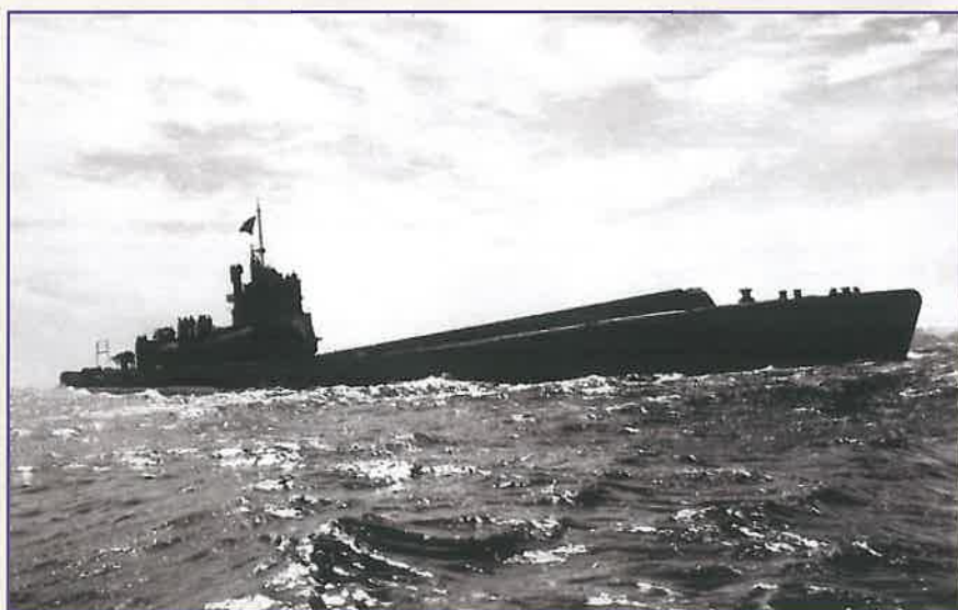
I 400 till sjöss, lägg märke till katapultrampen på fördäck.
